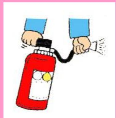
放射距離が 4~8m 位で放射時間も 12~16 秒位しかないので、無駄な噴出を避けるため、現場に行ってからピンを抜きレバーを操作するようにします。また有効距離 (4~5m) まで近づく事も大切です。
