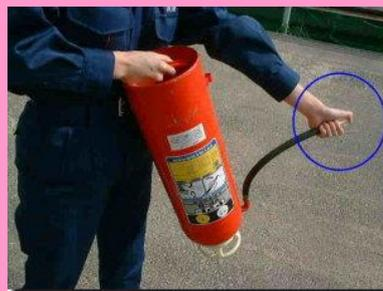
放射距離が6~10m位で放射時間も1分同程度なので、現場まで運んでから逆さまにした後、有効距離に進んで放射するようにします。
