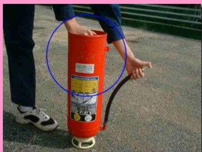
④ノズルを押さえていた指をはずし、火元に向け噴射する。
