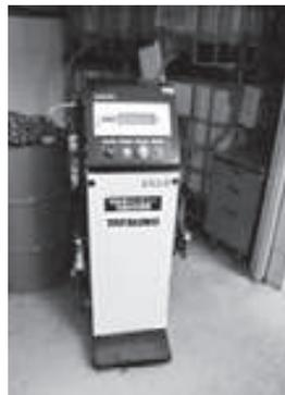
緊急用バッテリー可搬式計量機
